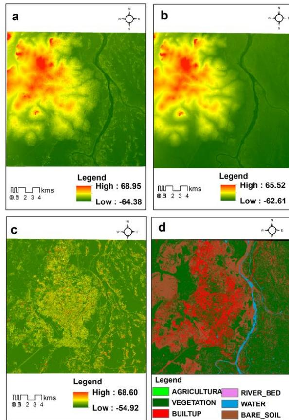
Figure 3. Input layers for UCPs derivation: (a) DSM; (b) DTM; (c) nDSM; (d) LULC.
