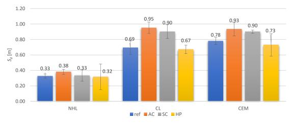
Figure 16. Diffusion equivalent air layer thickness values.
