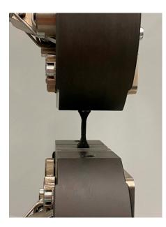
Figure 9. Universal Tensile Machine Inspekt Retrofit AGS-G 10 kN.
