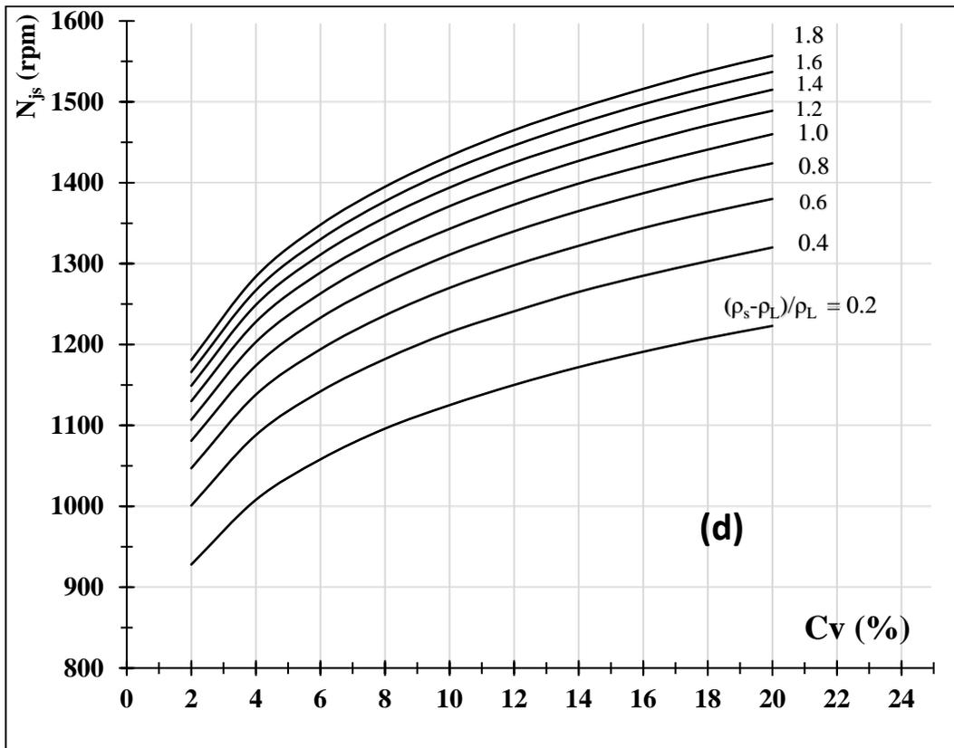
Figure 5.  $N_{js}$  calculation charts for different solid classes (a) Coarse silt (b) Fine sand (c) Medium sand (d) Coarse sand.
