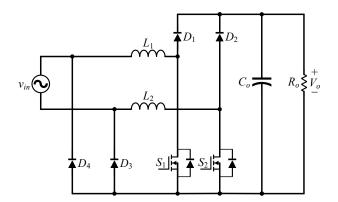
Figure 2. Semi-bridgeless PFC rectifier.
