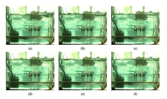
**Figure 13.** Experimental flow pattern before optimization. (**a**) 0.005 s. (**b**) 0.645 s. (**c**) 1.285 s. (**d**) 1.925 s. (**e**) 2.565 s. (**f**) 3.205 s.
