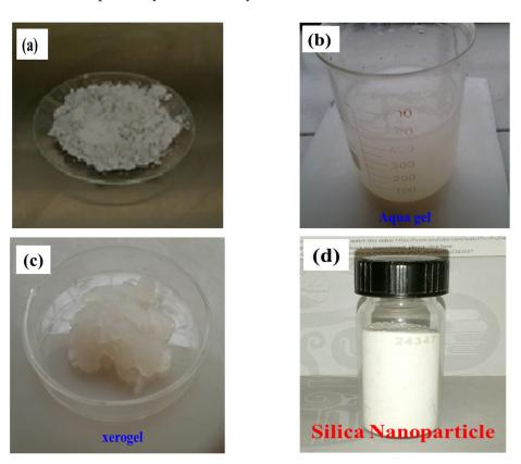
Figure 1. (a) SAFA, (b) silica aquagel, (c) silica xerogel, (d) silica nanoparticles.
