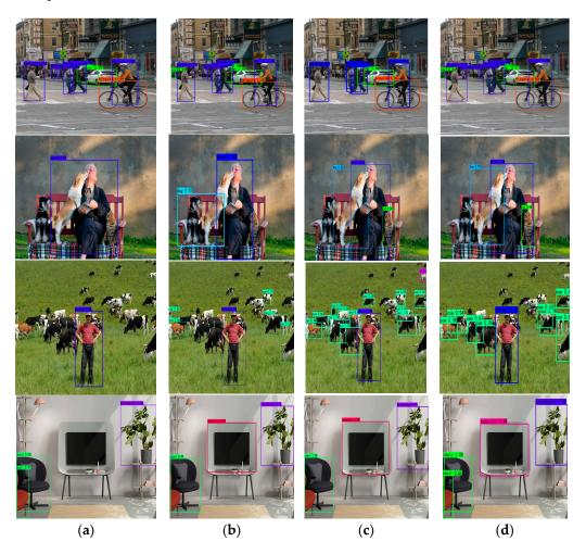
Figure 13. Comparison of detection effects. (a) YOLOv3; (b) YOLOv5; (c) SSD; (d) MAO-YOLOv5.
