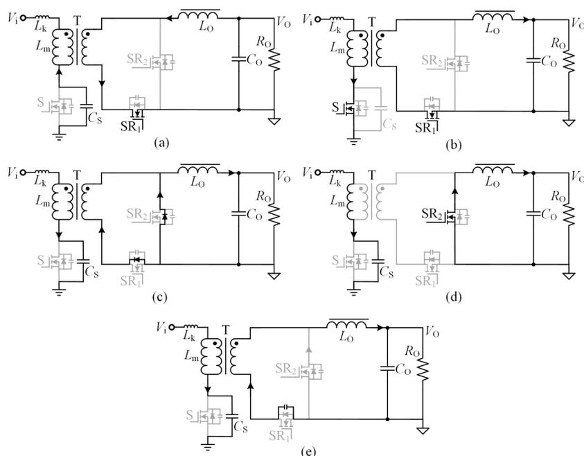
**Figure 3.** Equivalent circuits of each mode. (a) Mode 1 ( $t_0-t_1$ ); (b) mode 2 ( $t_1-t_2$ ); (c) mode 3 ( $t_2-t_3$ ); (d) mode 4 ( $t_3-t_4$ ); (e) mode 5 ( $t_4-t_0$ ).
