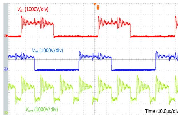
Figure 16. Waveforms of rectifier diode voltage  $V_{D1}$ ,  $V_{D6}$  and module rectifier output  $V_{rect}$ .
