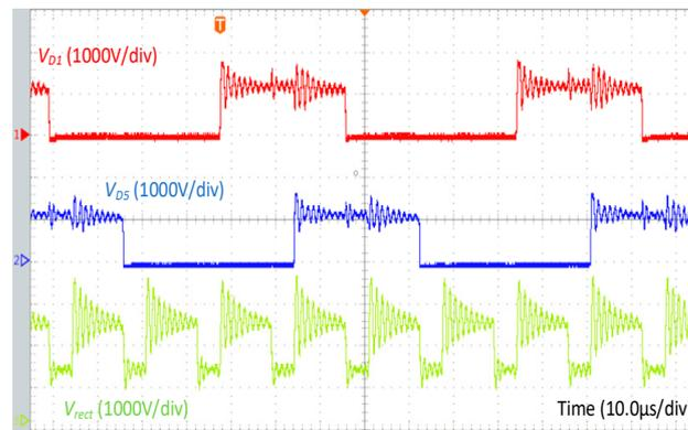
Figure 17. Waveforms of rectifier diode voltage  $V_{D1}$ ,  $V_{D5}$  and module rectifier output  $V_{rect}$ .
