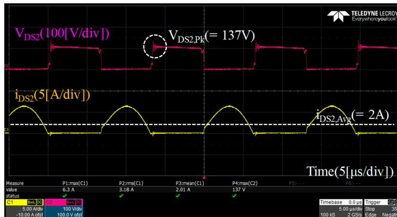
(c) Voltage and current on  $D_{S2}$  ( $V_{DS2}$  and  $i_{DS2}$ ).
