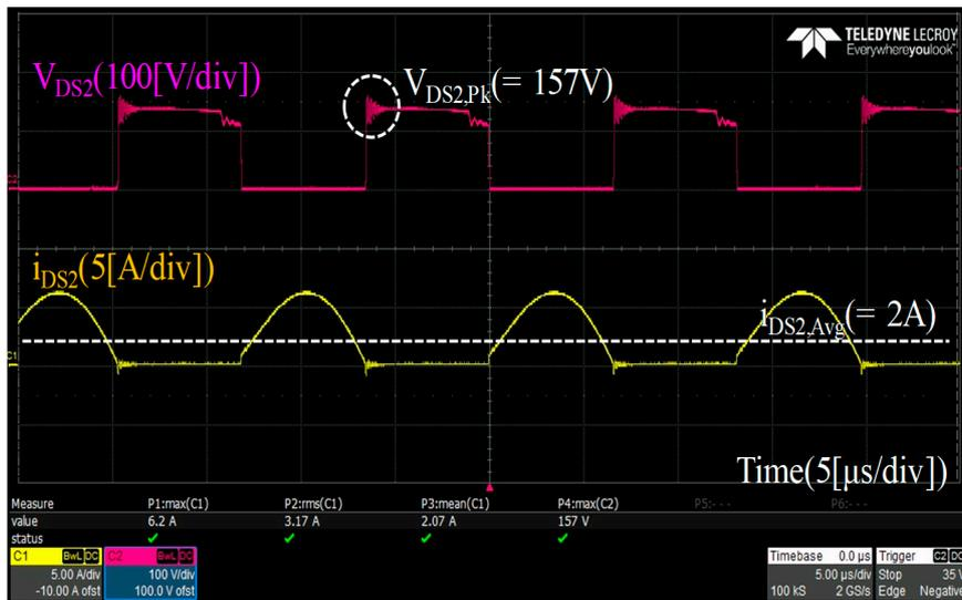
(c) Voltage and current on  $D_{S2}$  ( $V_{DS2}$  and  $i_{DS2}$ ).
