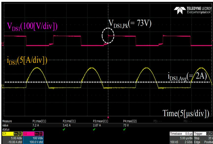
(b) Voltage and current on  $D_{S1}$  ( $V_{DS1}$  and  $i_{DS1}$ ).
