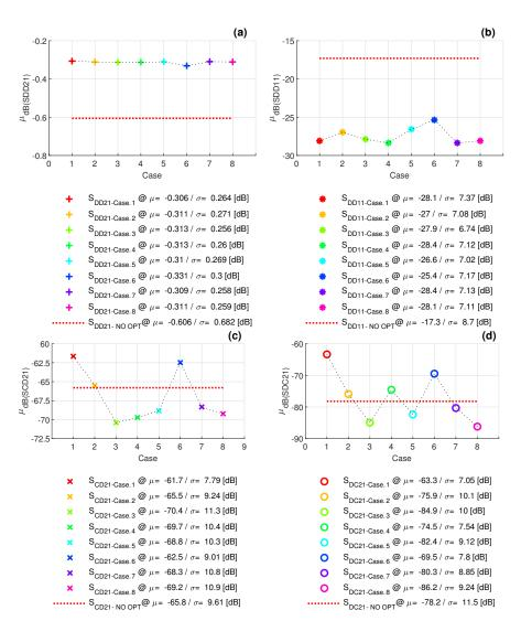
**Figure 11.** FoMs of  $D_{CtC}@D_{Stitch}$  and  $\Delta_S@OAR_S - L_{1,3}$  (SVO-phase results compared to the DPO output structure): (a)  $S_{DD21}$ ; (b)  $S_{DD11}$ ; (c)  $S_{DC21}$ ; (d)  $S_{CD21}$ .
