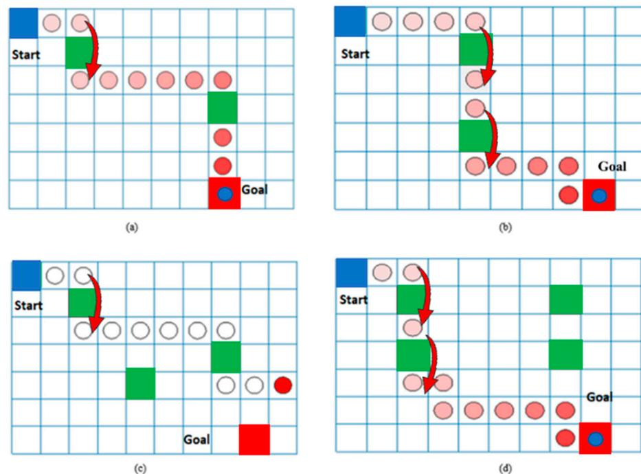
Figure 14. Path Traversed by the Agent (a,b) Two Obstacles (c) Three Obstacles (d) Four Obstacles using Double DQN Algorithm.
