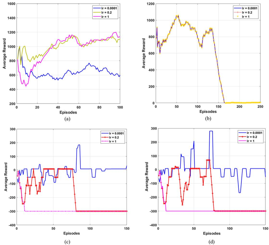
**Figure 11.** Convergence Speed with Different Learning Rate (a) Q-Learning (b) SARSA (c) DQN, and (d) Double DQN.
