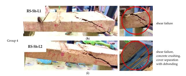
**Figure 15.** Failure mode of slabs: (a) CS1-N; (b) CS2-N; (c) CS 3-ETS; (d) RS-R-D10; (e) RS-R-D20; (f) RS-St-D10; (g) RS-St-D20; (h) RS-Sh-L1; (i) RS-Sh-L2.
