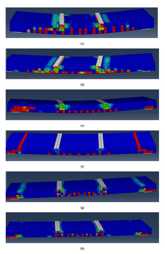
**Figure 25.** Failure mode for slabs using FE model: (a) CS1-N; CS2-N; (b) CS 3-ETS; (c) RS-R-D10; (d) RS-R-D20; (e) RS-St-D10; (f) RS-St-D20; (g) RS-Sh-L1; (h) RS-Sh-L2.
