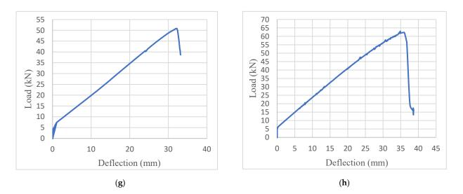
**Figure 13.** Load-deflection curve of slabs: (a) CS1-N; CS2-N; (b) CS3-ETS; (c) RS-R-D10; (d) RS-R-D20; (e) RS-St-D10; (f) RS-St-D20; (g) RS-Sh-L1; (h) RS-Sh-L2.
