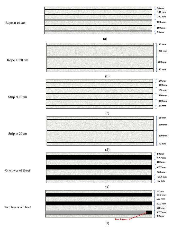
**Figure 9.** Repair configuration: (a) RS-R-D10; (b) RS-R-D20; (c) RS-St-D10; (d) RS-St-D20; (e) RS-Sh-L1; (f) RS-Sh-L2.
