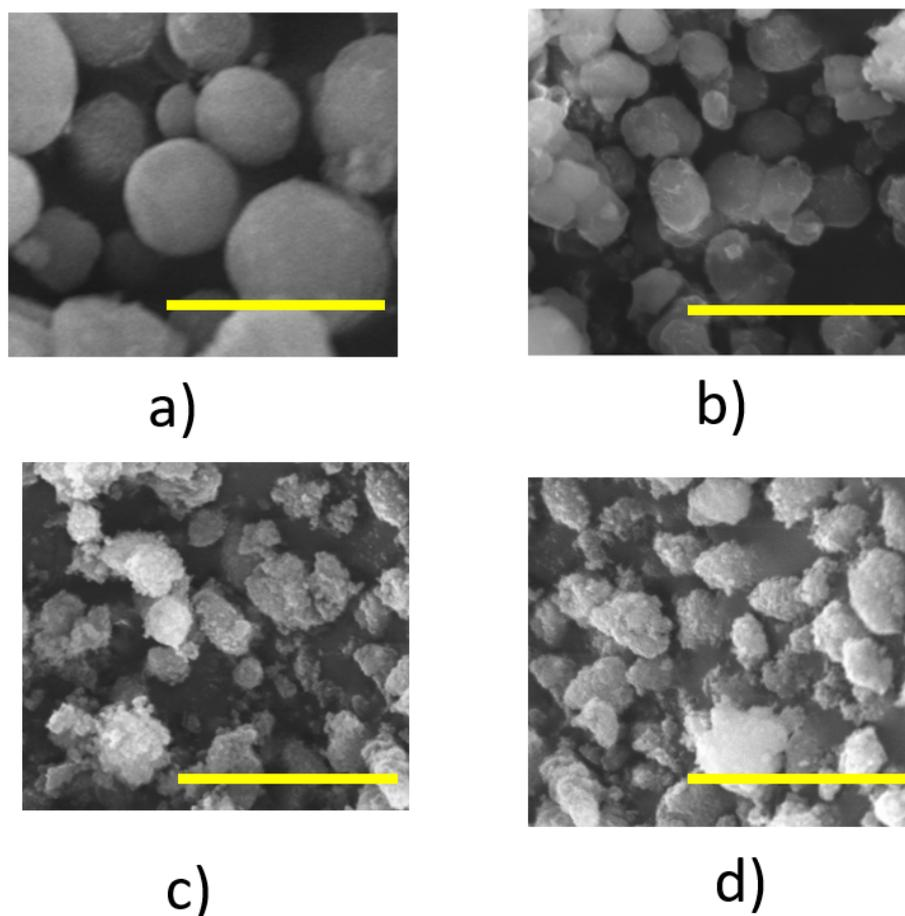
**Figure 2.** SEM images of (a)  $\text{CaCO}_3\text{-E}$ ; (b)  $\text{CaO-E/C}_6$ ; (c)  $\text{CaCO}_3\text{-CuCO}_3$ ; and (d)  $\text{CaO-CuO}$  (The yellow line represents scale bar: 5  $\mu\text{m}$ ).
