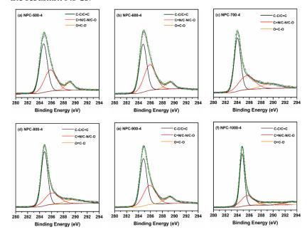
**Figure 3.** C1s XPS spectra of NPC-500-4 (**a**), NPC-600-4 (**b**), NPC-700-4 (**c**), NPC-800-4 (**d**), NPC-900-4 (**e**) and NPC-500-4 (**f**).
