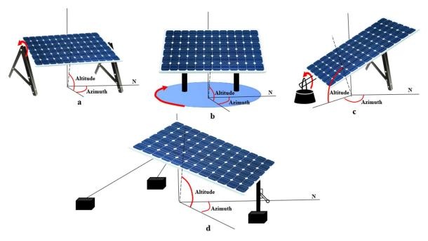
Figure 3. Various Single-axis Solar Tracking Systems. (a) HSAT; (b) VSAT; (c) PASAT; (d) TSAT.
