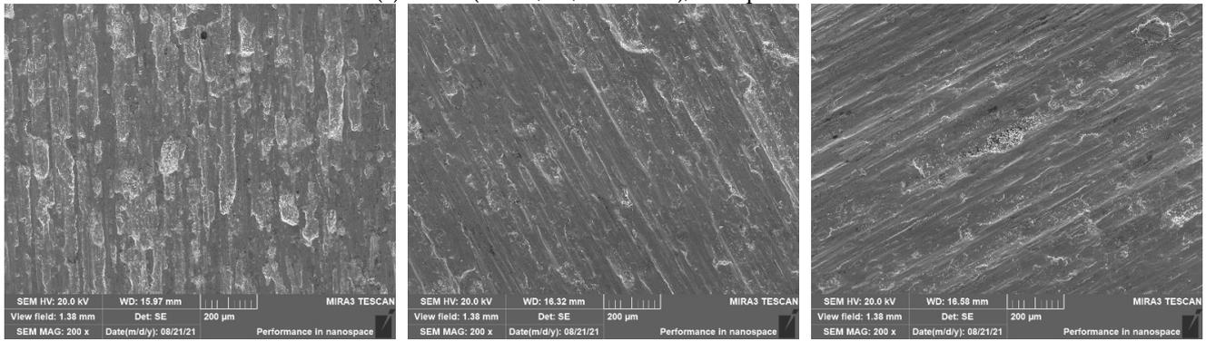
(d) SS316 ( $F = 10, 30, \text{ and } 50 \text{ N}$ ), pin specimen
