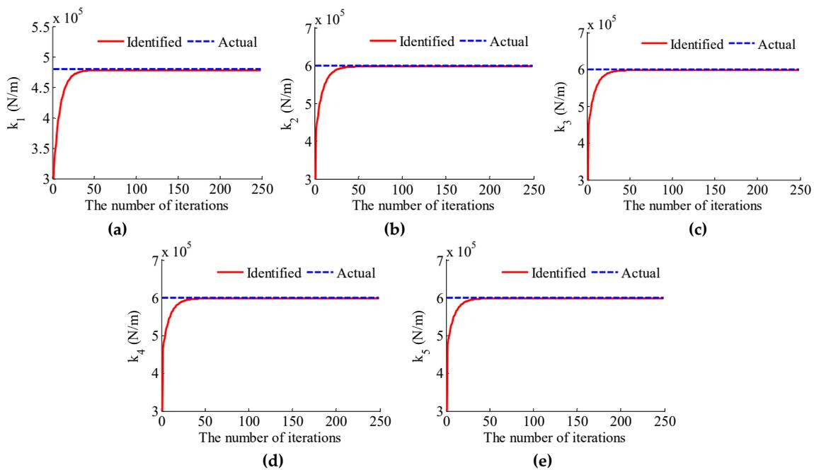
**Figure 4.** The identified structural parameters (10% noise): (a)  $k_1$ ; (b)  $k_2$ ; (c)  $k_3$ ; (d)  $k_4$ ; (e)  $k_5$ .
