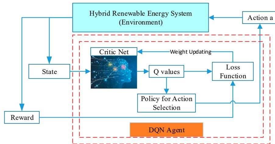
Figure 3. A graph of DQN-based EMS.
