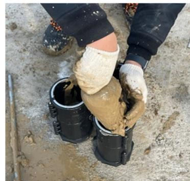
(d) Specimen fabrication for subbase CLSM
