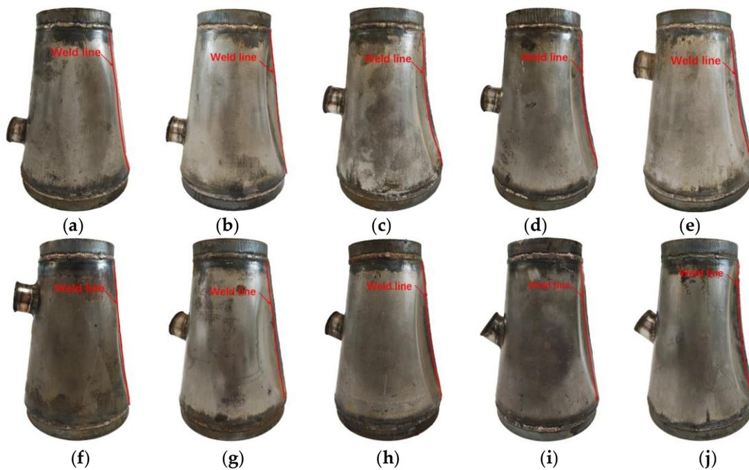
**Figure 8.** Conical shells with an opening after failure. (a) CS-1/4-0-1, (b) CS-1/4-0-2, (c) CS-2/4-0-1, (d) CS-2/4-0-2, (e) CS-3/4-0-1, (f) CS-3/4-0-2, (g) CS-2/4-15-1, (h) CS-2/4-15-2, (i) CS-2/4-30-1, (j) CS-2/4-30-2.
