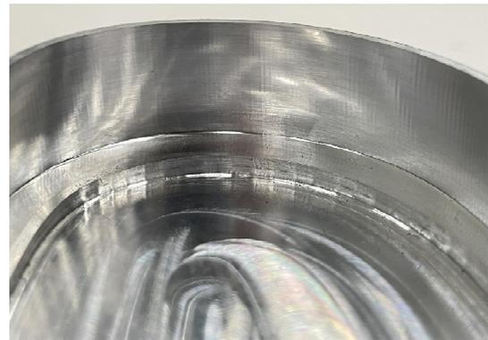
(d) roughness:  $Ra = 0.175 \mu\text{m}$
