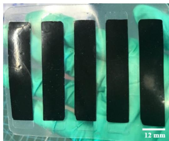
Figure 3. C-PDMS strip sheets embedded into the PDMS layer.
