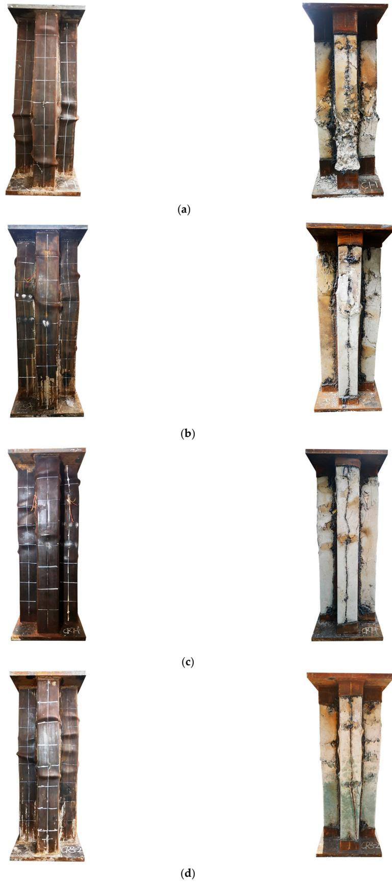
Figure 5. Failure patterns of specimens. (a) C0, (b) CR1-1, (c) CR2-1, (d) CR3-2.
