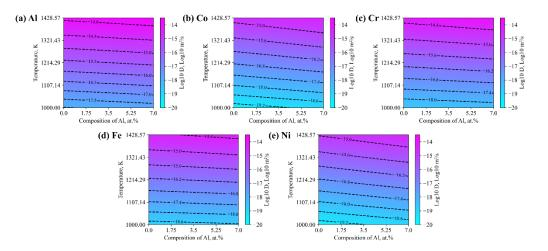
**Figure 6.** Influence of aluminum content on the tracer diffusion coefficients of the Alx(CoCrFeNi)1-x alloys: (a)  $D_{Al}^*$ ; (b)  $D_{Co}^*$ ; (c)  $D_{Cr}^*$ ; (d)  $D_{Fe}^*$ ; (e)  $D_{Ni}^*$ .
