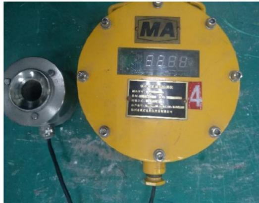
Figure 11. Load tester of the GDP60 bolt.
