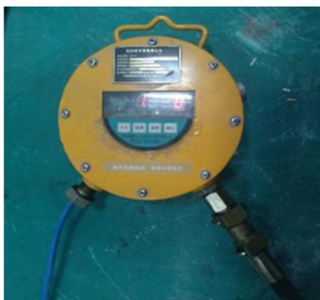
**Figure 10.** Comprehensive parameter tester of the CD-4 bolt.
