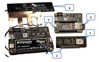
Figure 27. UBIRCH Testkit hardware Components.
